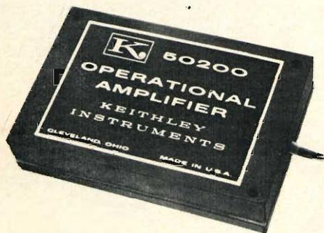
Il mod. 50200 può essere usato sia come amplificatore lineare che logaritmico, integratore di corrente, amplificatore di carico o ad alta resistenza d'entrata.
